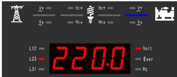
EX. Calibración de la fase de fuente de emergencia L23 Figura 22
