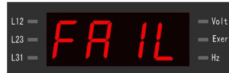
Falla de calibración Figura 25
