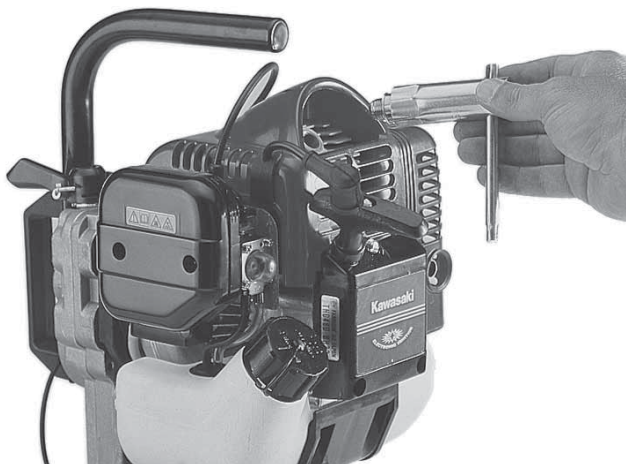
FIG. 29 – LIMPIEZA DE LA BUJÍA DE ENCENDIDO
