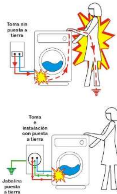
Figura 3. Puesta a tierra de equipos
