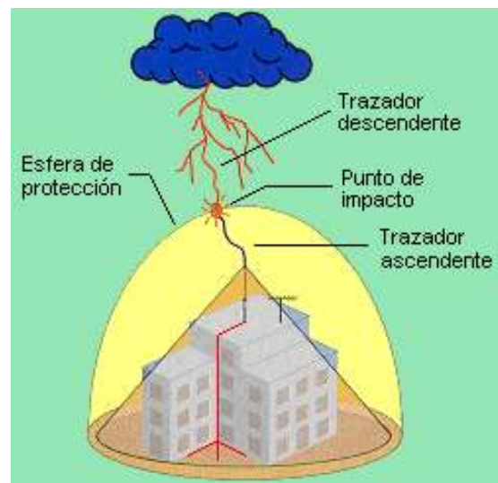
Figura 7. Pararrayo con sistema de cebado
