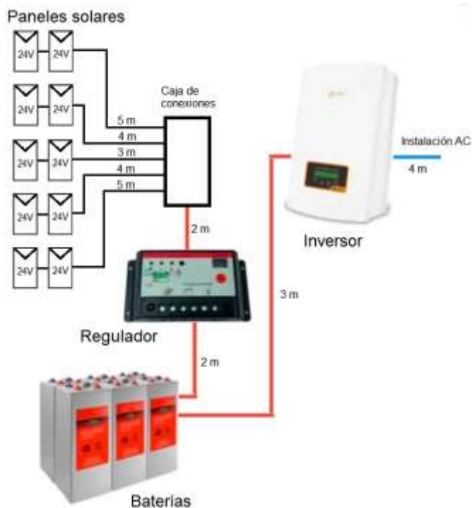
Figura 2. Distancias de instalación ejemplo 1
