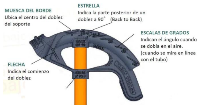
Figura 3. Partes del doblador manual
