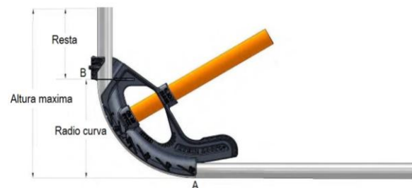
Figura 18. Doblado de tubería a 90°
