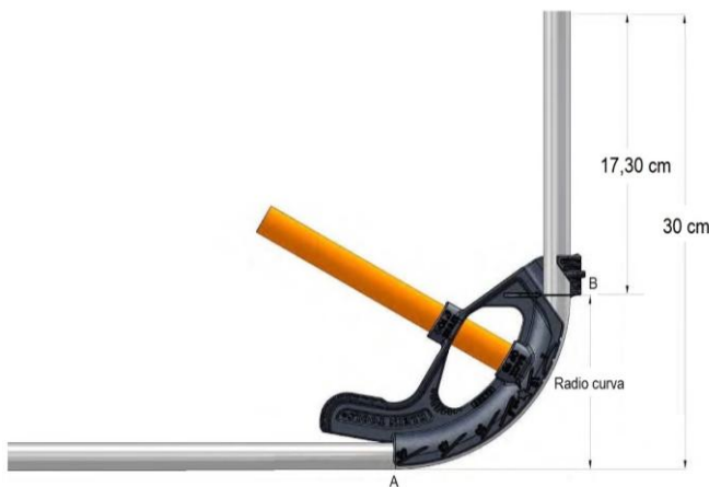
Figura 16. Doblado de tubería a 90°
