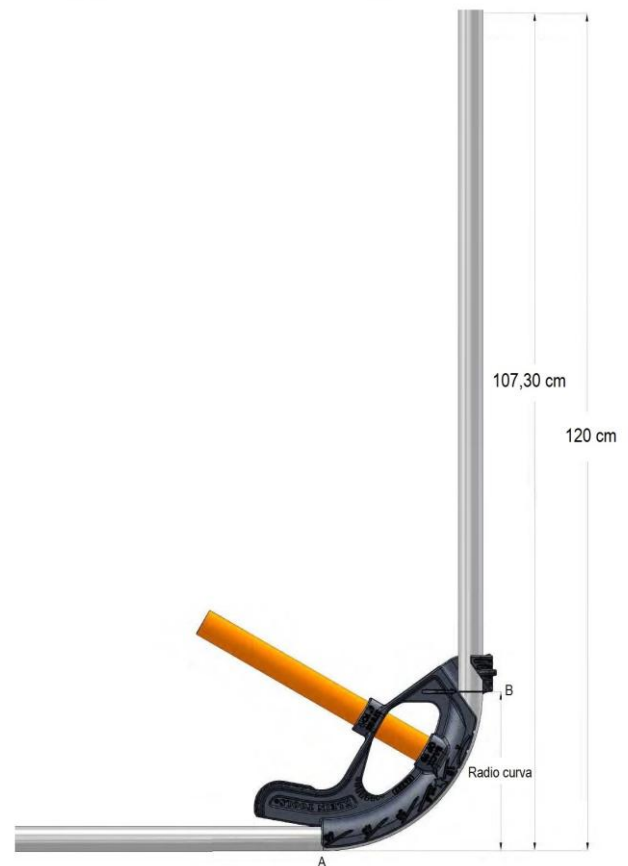
Figura 12. Doblado de tubería a 90°
