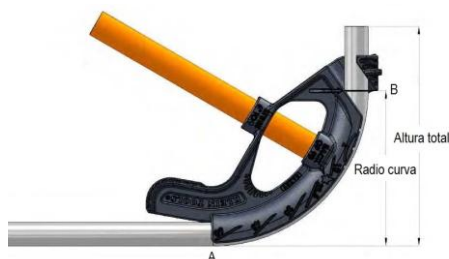
Figura 8. Doblado de tubería a 90°
