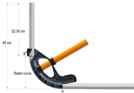
Figura 26. Doblado de tubería a 90°
