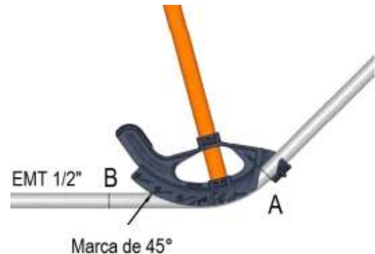
Figura 66. Dobles a 45° en la primera marca
