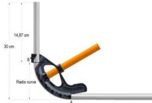
Figura 34. Doblado de tubería a 90°
