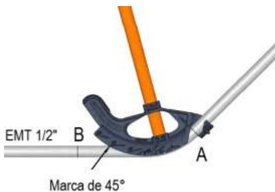
Figura 48. Doble a 45° en la primera marca
