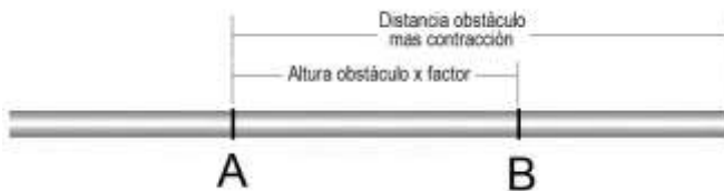
Figura 42. Marcación del primer punto
