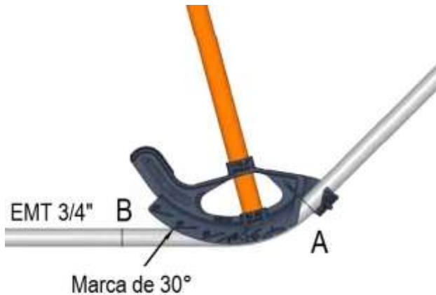
Figura 56. Dobleza a 30° en la primera marca
