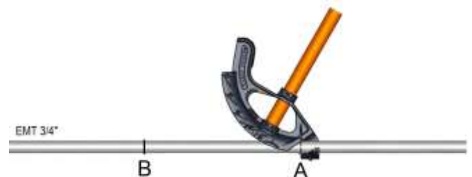
Figura 55. Colocación del doblador en el primer punto
