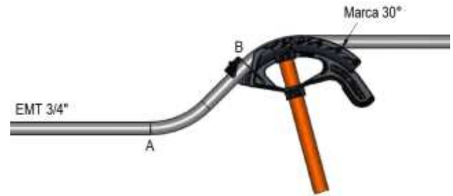
Figura 58. Dobleza a 30° en la segunda marca
