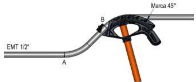
Figura 50. Doble a 45° en la segunda marca
