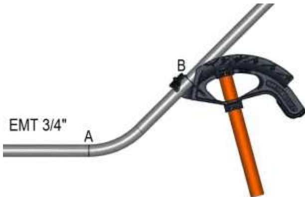
Figura 57. Colocación del doblador en la segunda marca
