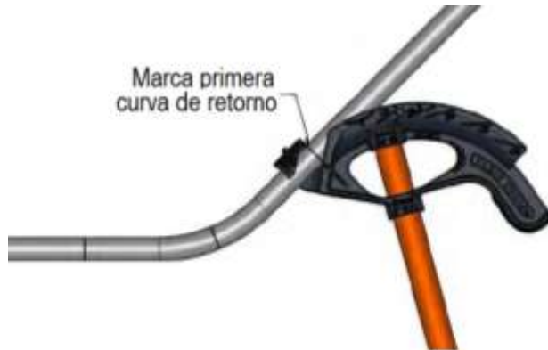
Figura 116. Doblado de la primera curva de retorno
