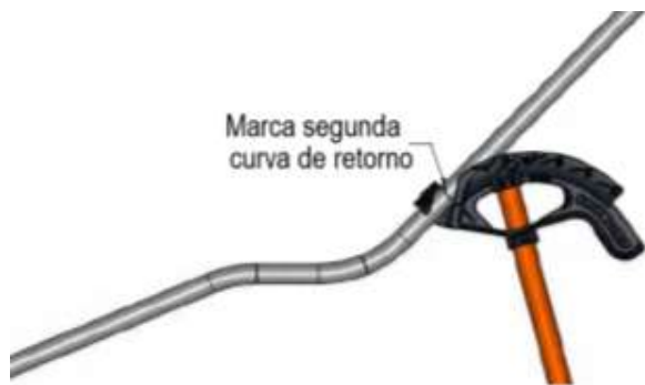
Figura 107. Doblado de segunda curva
