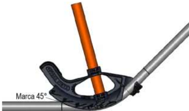
Figura 103. Doblado de la tubería hasta marca de 45°
