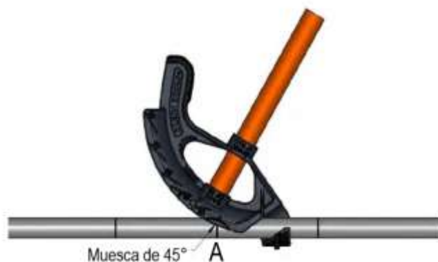
Figura 113. Colocación del doblador con muesca al centro
