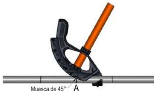
Figura 100. colocación del doblador con muesca al centro
